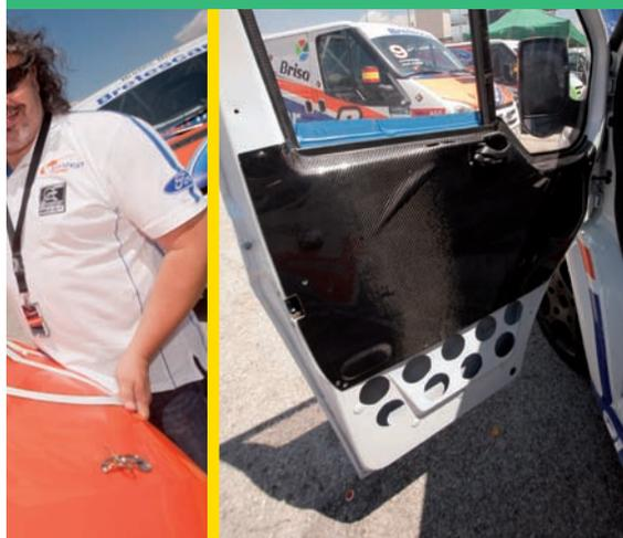
Fibra de vidrio en puertas laterales, trasera y capó, así como los revestimientos de las puertas delanteras.
